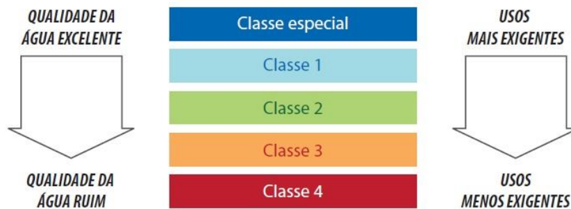
Figura 1.1- Classes de Enquadramento e sua relação com a qualidade da água e seus usos.
